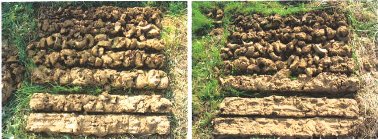
Slika 15 Usporedba tla iz nabušene jezgre dviju najudaljenijih lokacija, Oborovo-jug (lijevo) i Novaki Oborovski (desno). Očito je da i već opći dojam govori o tlu sasvim sličnih karakteristika.
