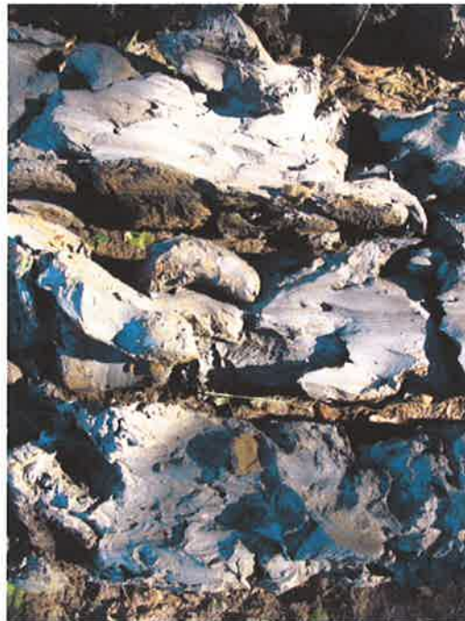
Slika 9 CH prašinstva glina mekog do vrlo mekog konzistentnog stanja nabušena u B1/PO2, od 5 do 8 m.
