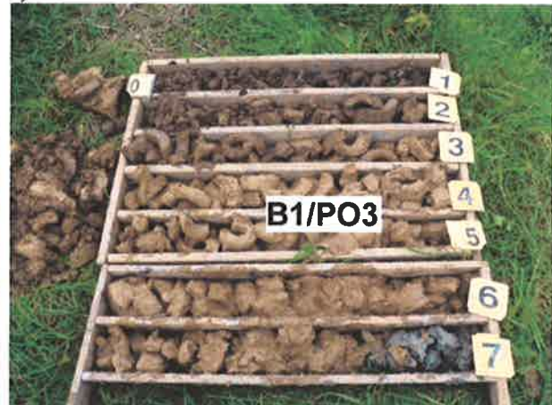
Slika 11 Istražno bušenje na lokaciji PO3 (a) Pozicija istražne bušotine (b) Nabušena jezgra
