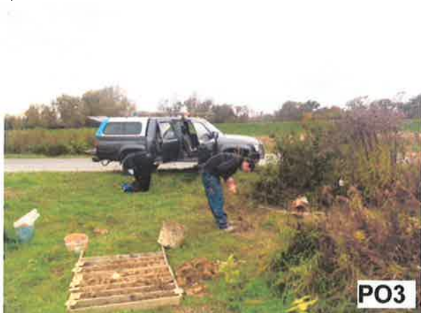
Slika 11 Istražno bušenje na lokaciji PO3 (a) Pozicija istražne bušotine (b) Nabušena jezgra
